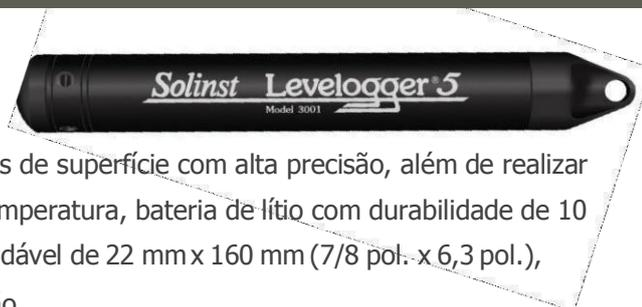
O Levellogger 5 registra níveis de águas subterrâneas e níveis de águas de superfície com alta precisão, além de realizar medições de temperatura. Ele reúne sensor de pressão, detector de temperatura, bateria de lítio com durabilidade de 10 anos e registrador de dados selados dentro de um invólucro de aço inoxidável de 22 mm x 160 mm (7/8 pol. x 6,3 pol.), com um revestimento anticorrosivo que utiliza tecnologia de polimerização.
