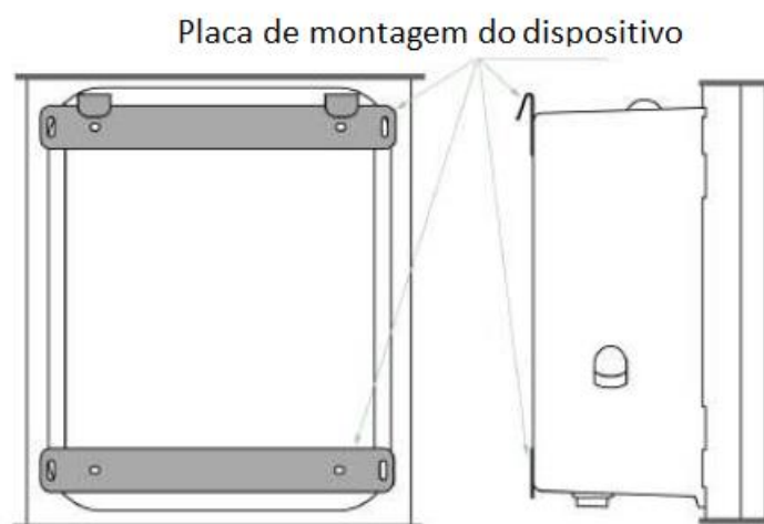
2. Figura 3.7 esquema da placa de montagem do dispositivo no gabinete
