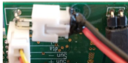
Figura 8: Encaixe do cabo da bateria
