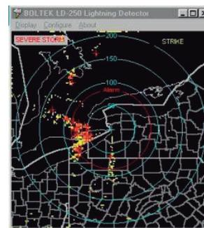
Conecte um Receptor GPS LDGPS-1 ou Bússola Eletrônica LDC-1 opcionais ligados ao seu LD-250 e rastreie o raio do seu carro, caminhão ou barco. Ligue o indicador de rumo do LD-250 quando estiver no modo portátil. O triângulo azul no centro da tela irá rotacionar para demonstrar o uso do GPS ou bússola acompanhar as mudanças de direção do seu veículo.
