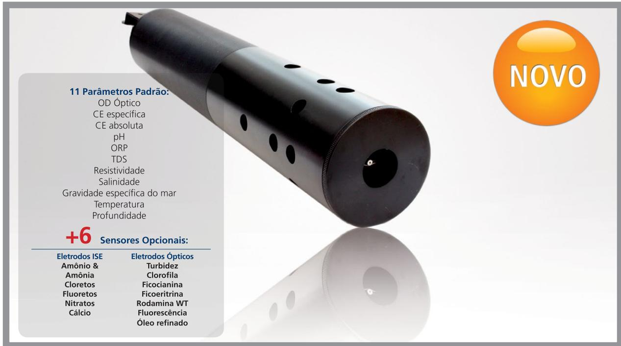
A sonda multiparâmetro AP-7000 foi desenvolvida para operar durante longo período de tempo, permitindo monitorar até 19 parâmetros simultaneamente. Além dos 11 parâmetros padrão – OD Óptico, CE específica e absoluta, pH, ORP, TDS, Resistividade, Salinidade, Gravidade Específica do mar, Temperatura e Profundidade – a sonda possui 6 portas auxiliares para inserção de outros eletrodos definidos pelo usuário, em qualquer combinação.
